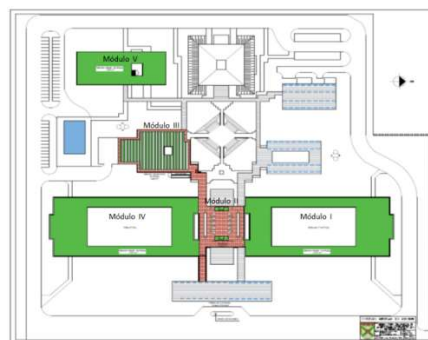
Figura 03 – Projeto do telhado verde no CMR .
